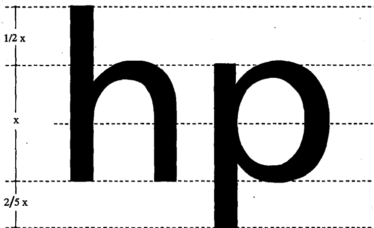
Proporción de las ascendentes de \frac{1}{2}x y las descendentes de \frac{2}{5}x en la fuente Univers.
