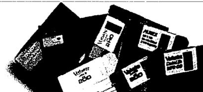
ancho de una pulgada, existen por lo tanto diskettes de 48 pistas por pulgada (TPI o Traks per inch), 96 tpi o 135 tpi, dependiendo del diámetro y densidad del disco. Asimismo, las pistas magnéticas, están divididas en sectores, y el modo en que un disco se «sectoriza», determina el formato del mismo. Para poder utilizarse, los discos deben formatearse.
